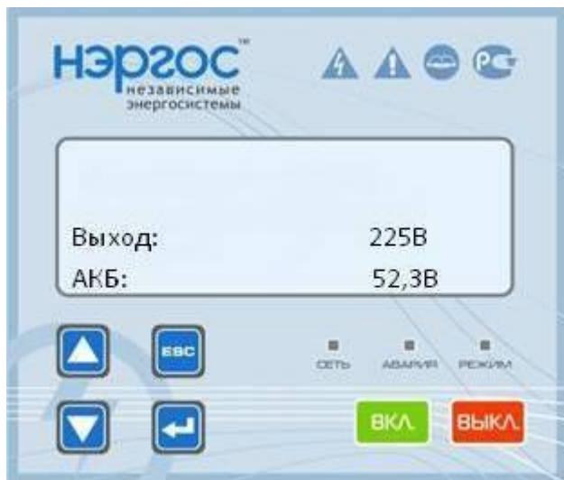
3.2. ИБП находится в режиме инвертирования, внешняя питающая сеть отсутствует. На экран выводятся данные о нагрузке, выходном напряжении ИБП и напряжении АКБ.
