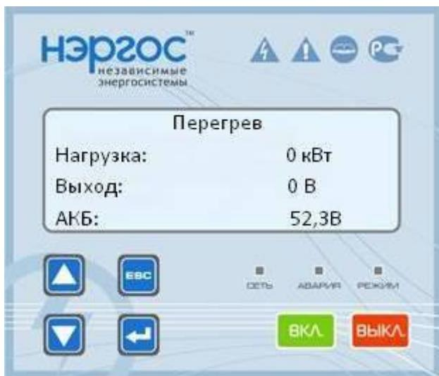
2.4. Индикация общей неисправности ИБП. Обратитесь в сервисный центр. При первоначальном запуске проверьте автомат защиты АКБ. Если авария возникла во время работы ИБП, обратитесь в сервисный центр. Внимание: Автомат защиты при этом не включать.
