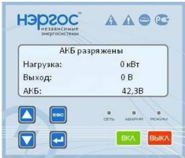
2.2. Превышение нагрузкой пиковой мощности ИБП. В частности такую аварию могут вызывать пусковые токи нагрузки, короткое замыкание в нагрузке. Для сброса данной аварии нажмите кнопку ВЫКЛ. Далее произведите запуск ИБП (нажатием кнопки ВКЛ) и убедитесь что данная аварийная ситуация не возникла вновь. При повторении аварии после перезапуска ИБП, проверьте нагрузку.
